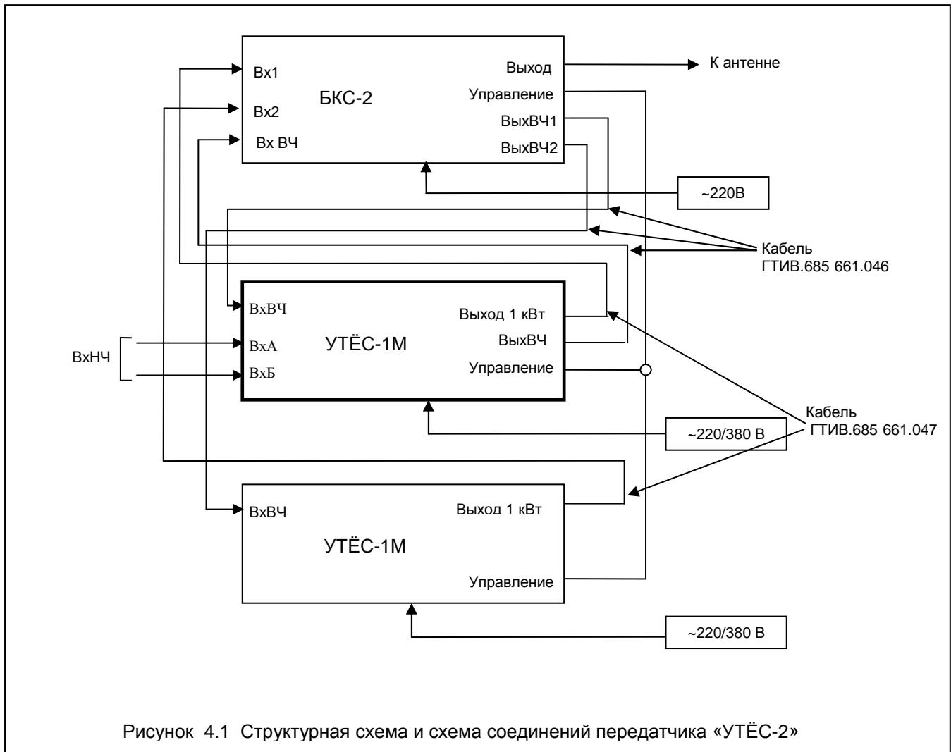
Конструктивно передатчик выполнен в виде трёх блоков:
